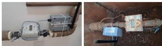
Figura 10 – End-devices instalados para realização dos testes de campo.
