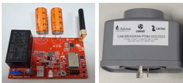
Figura 4 – Dispositivo roteador com circuito amplificador de potência.
